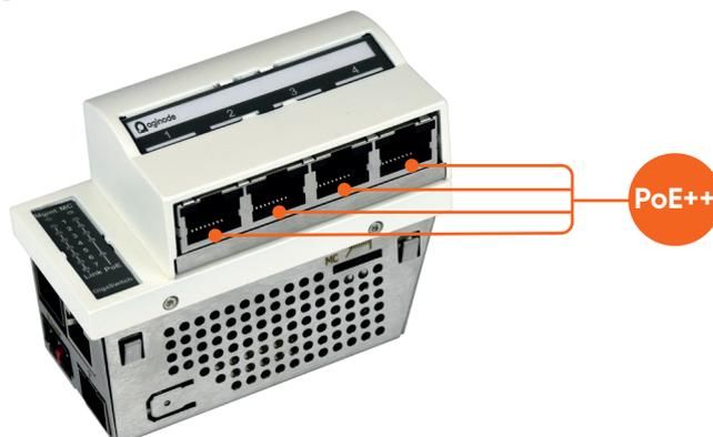
Mittels Power over Ethernet (PoE) ist es möglich neben Daten auch Strom über ein achtadriges Netzkabel zu übertragen. Die nachstehende Tabelle zeigt welche Leistungen mit den unterschiedlichen Standards möglich sind.
